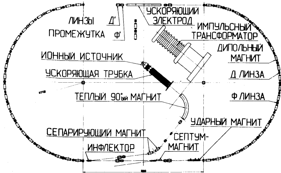
Рис.1. Общая схема ускорителя СПИИ.
