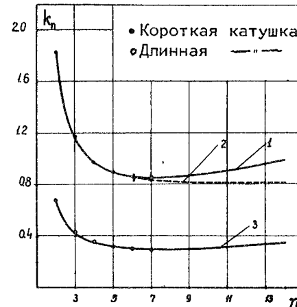
Рис.4. Сравнение расчетных и экспериментальных результатов: 1,3 - расчетные величины k_n для короткой и длинной катушек с учетом величины сечения обмоток, 2 - короткая катушка при F_m = 0 .
