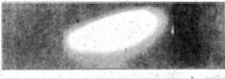
Рис. 2. Автограф пучка дейтронов на рентгеновской фотопленке, помещенной в магнитный канал. (Импульс Pd = 9,4 Гэв/с, поток - 5 \cdot 10^{10} дейтронов).
