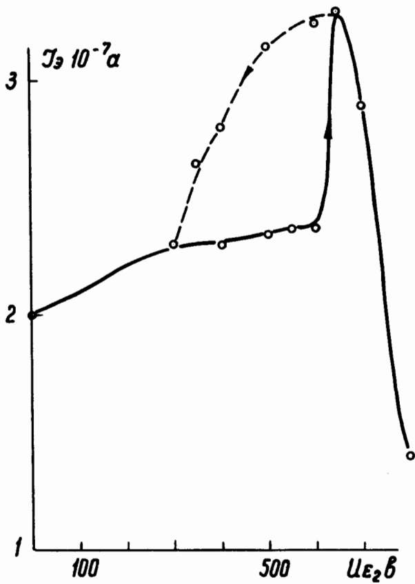
Рис.6. Зависимость J_{\theta} от U_{E2} при U_k = 440 в, J_k = 95 мка, B=3780 э.
