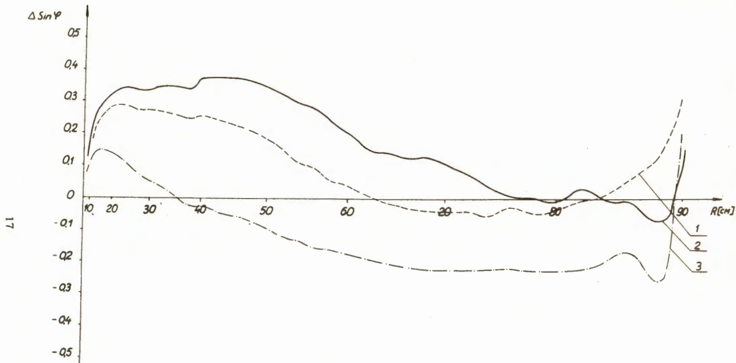
Рис.6. Фазовое движение ионов. 1 - \frac{A}{Z} = -2,8 ; 2 - \frac{A}{Z} = 3,2 ; 3 - \frac{A}{Z} = 4 .
