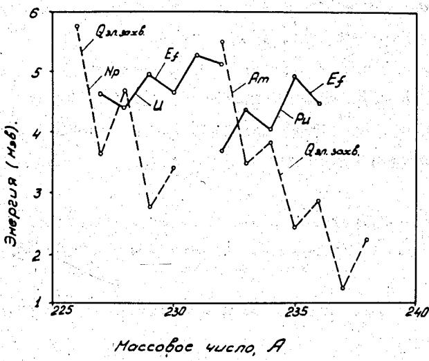
Зависимость расчётных величин энергии К -захвата изотопов америция и нептуния (пунктир), а также барьеров деления изотопов плутония и урана (сплошная линия) от массового числа  $A$ .
