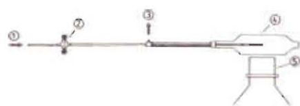
Рис. 2. Установка для измерения прохождения аэрозолей через фильтр. 1 - аэрозольная струя с продуктами ядерных реакций, 2 - держатель ядерного фильтра / \Phi = 2 см/, 3 - отвод газа, 4 - пластмассовая трубка / V = 180 мл/, 5 - - Ge - детектор.
