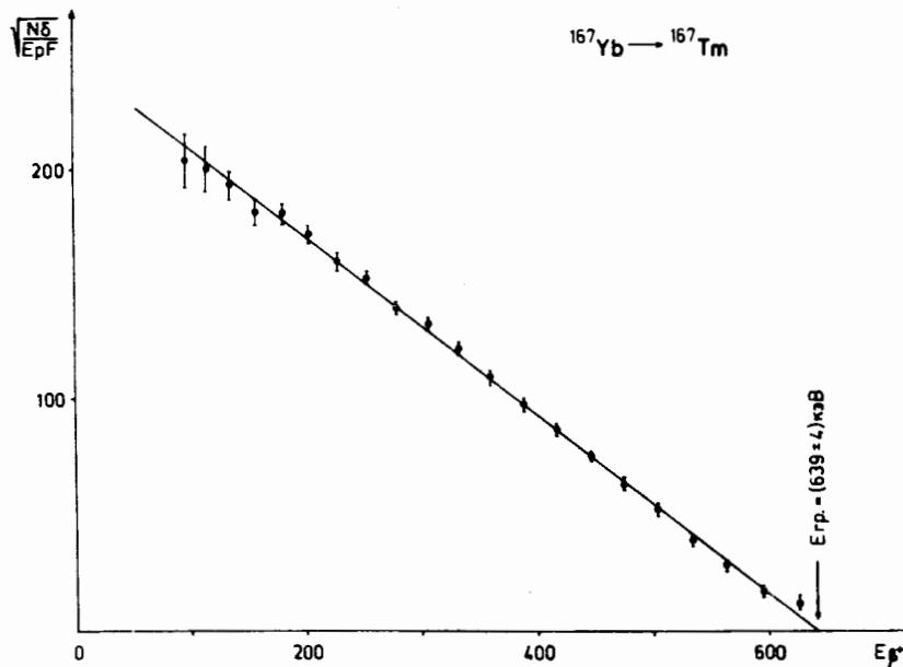
Полученные значения граничной энергии  $E_0$ , отношения  $J_{\beta^+}/J_{K116,6}$  и интенсивности позитронов  $J_{\beta^+}$  в % на распад  $^{167}\text{Yb}$  приведены в табл. 1.
