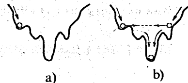
Рис. 3. Поиск глобального минимума стандартным методом (a) и гравитационным методом (b)
