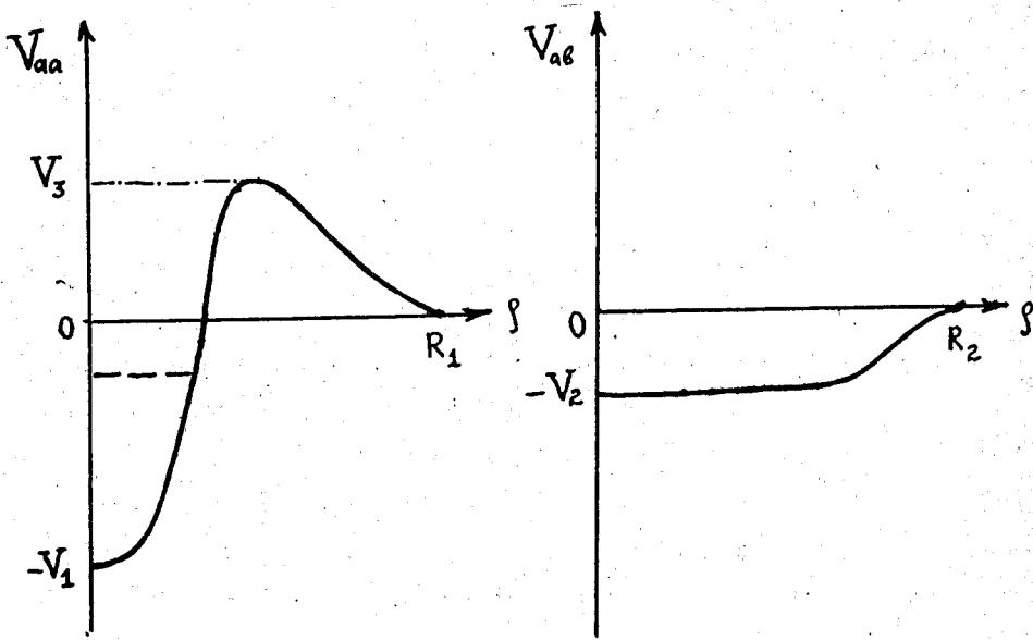
В потенциале  $V_{aa}$  имеется по крайней мере одно связыванное состояние для системы  $(a+a)$ . Отталкивающий барьер в  $V_{aa}$  затрудняет соединение частиц в реакции II.
