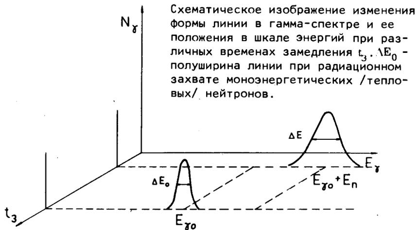
Схематическое изображение изменения формы линии в гамма-спектре и ее положения в шкале энергий при различных временах замедления  $t_3$ .  $\Delta E_0$  - полуширина линии при радиационном захвате моноэнергетических /тепловых/ нейтронов.
