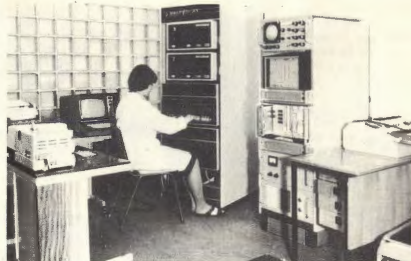
Рис. 5. Аппаратура измерительного модуля спектрометра малоуглового рассеяния.
