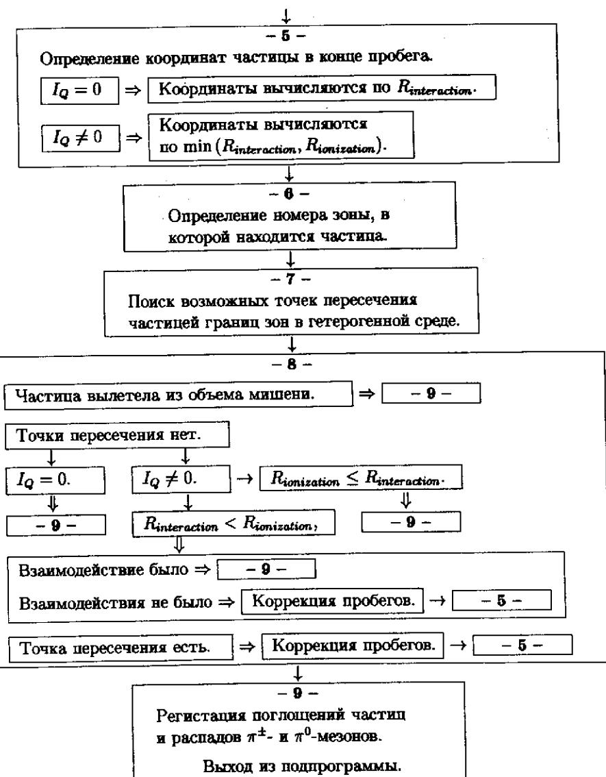
Следует отметить, что при моделировании и коррекции пробегов частицы подпрограмма ENLOSS учитывает наличие или отсутствие вещества в той зоне мишени, где в данный момент находится частица. Учитываются также свойства
