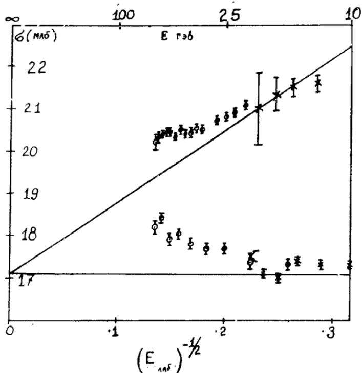
Рис. 2. Полные сечения  $K^{\pm}$ -рассеяния как функции величины  $(E_{LAB})^{-1/2}$ . Экспериментальные данные те же, что и на рис. 1.
