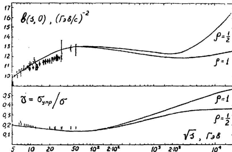
Рис. 12. Параметр наклона дифракционного конуса при  $t = 0$  ( $b(s, 0)$ ) и отношение упругого сечения к полному  $\delta$  для pp-рассеяния в модели быстрого роста.  $\rho$  - асимптотическое значение величины  $\delta$ . Экспериментальные данные /20-23/ (приведены только статистические ошибки).
