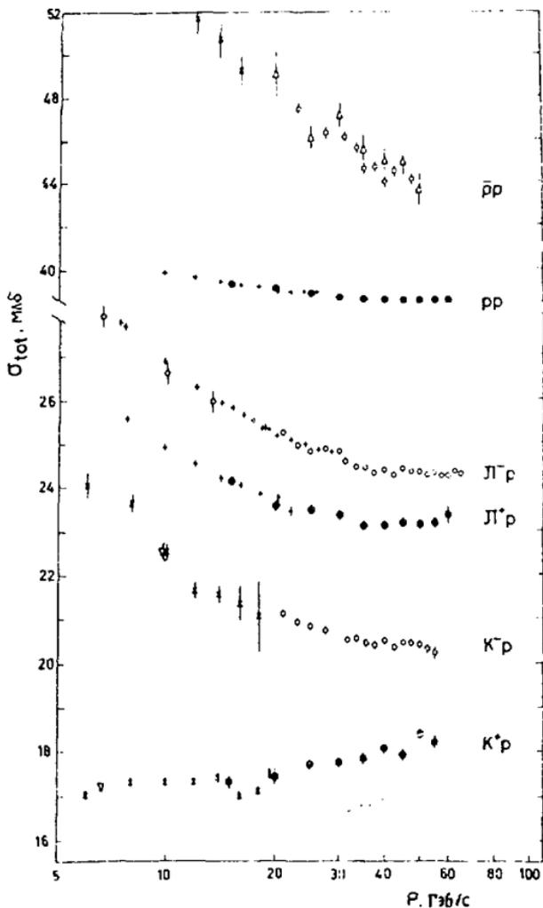
Рис. 1. Полные сечения  $\bar{p}^+p$ ,  $K^+p$ ,  $pp$ - и  $\bar{p}p$ -рассеяния при энергиях  $E \leq 60$  Гэв: светлые и темные кружки - результаты первых трех работ в /1/;  $\Delta$  - данные ранних измерений в Серпухове (четвертая работа в /1/);  $+$  - Данные из /30/ и  $\times$ -данные из /29/.
