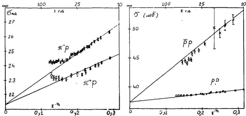
Рис. 3. Полные сечения  $\pi^{\pm}p$ ,  $p\bar{p}$ - и  $p,p$ -рассеяния как функции величины  $(E_{\text{lab}})^{-1/2}$ . Экспериментальные данные те же, что и на рис. 1.
