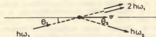
Рис. 10. Аномальное рассеяние света на частице, движущейся в преломляющей среде. Падающий фотон h\omega_1 вызывает индуцированный фотон и, кроме того, возникает рассеянный фотон h\omega_2 . Соответствующий этому спонтанный процесс - одновременное испускание фотонов h\omega_1 и h\omega_2 /двухфотонный эффект Вавилова-Черенкова/. В обоих случаях необходимо, чтобы было \beta n(\omega_1) \cos \theta_1 > 1 и \beta n(\omega_2) \cos \theta_2 > 1 или наоборот.
