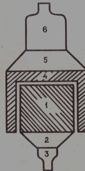
Рис. 1. Конструкция дозиметра: 1 - детектор нейтронов; 2, 5 - световоды, 3, 6 - фотоумножители, 4 - охранный сцинтиллятор.
