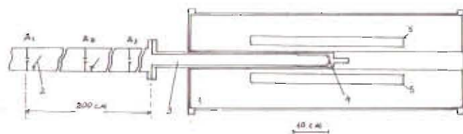
Рис. 1. Схема установки для изучения реакции ^{10}\text{Be}(p, n) на пучке ускорителя Ван-де-Граафа. Д1, Д2, Д3 - диафрагмы; 1 - корпус нейтронного детектора; 2 - выдвижной медный коллектор тока пучка; 3 - цилиндр Фарадея; 4 - мишень; 5 - ^3\text{He} -счетчики.
