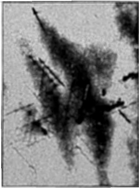
Рис. 1. ХТЕМ-светлопольное изображение структуры слоя кремния [111], имплантированного ионами бора с энергией E=13.6 МэВ до флюенса Ft=3 \cdot 10^{15} ион/см 2 . Температура отжига 800^{\circ}\text{C} в течение 30 мин. Стрелка указывает направление на поверхность образцов
