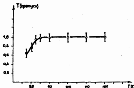
Рис. II. Зависимость пропускания ИК-излучения пленки от температуры.
