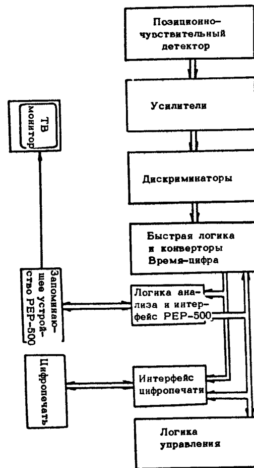
Рис. 1. Функциональная схема установки "Уран".
