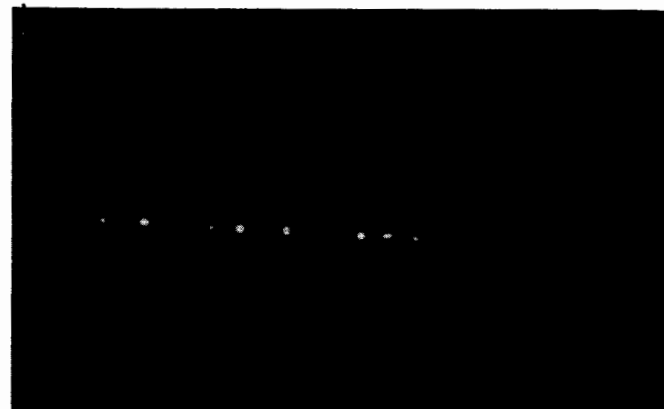
Рис. 1. Фотография следа электрона в водороде в направлении, параллельном электрическому полю, E = 32,5 кВ/см, с добавкой: 1% \text{CH}_4 + 0,05\% \text{H}_2\text{O} . Диафрагма объектива D = 2,5 , длина трека 16 см.
