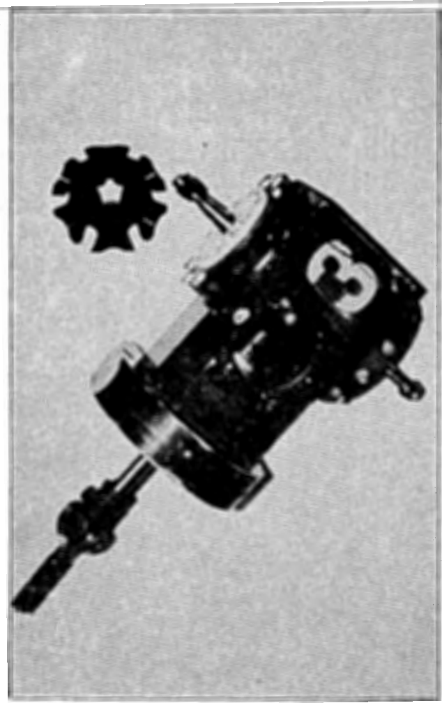
Рис. 4. Мальтийский механизм и мальтийский крест
