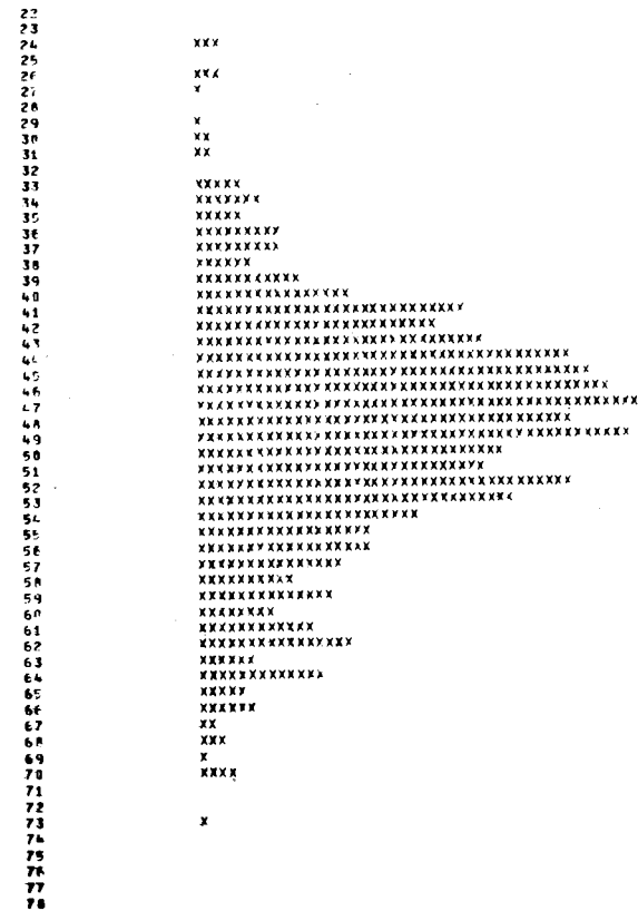
Рис. 11. Гистограмма отклонений координат в ДК1 от трека. Шаг гистограммы - 0,04 мм.
