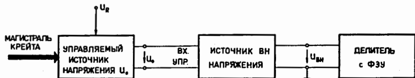
Рис. 1. Схема управления источника ВН, работающего по схеме преобразования постоянного напряжения в переменное.
