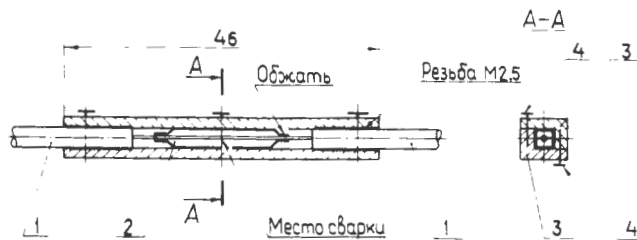
Рис. 8. Конструкция защитной муфты: 1 — световод; 2 — бандажный V-образный профиль; 3 — половинки защитной муфты; 4 — стяжные винты.
