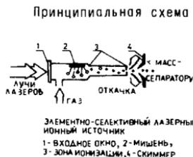
Принципиальная схема изображено на рисунке. Пучок тяжелых ионов бомбардирует мишень, расположенную в трубке, по которой пропускается очищенный инертный газ -  $He, Ne, Ar$ . Степень очистки газов определяется вероятностью образования соединений исследуемых атомов (ионов) с присутствующими в газе примесями и составляет  $10^{-5} - 10^{-6}$ . Максимальное давление газа в трубке 120 Торр, ограничивается оно возможностями дифференциальной откачки ( $1 \text{ м}^3/\text{с}$  при давлении 0,1 Торр).
