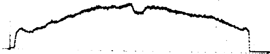
Рис. 7. Однородность детектора по его длине. Ширина входного окна - 6 мм, напряжение U_a = 9,8 кВ.
