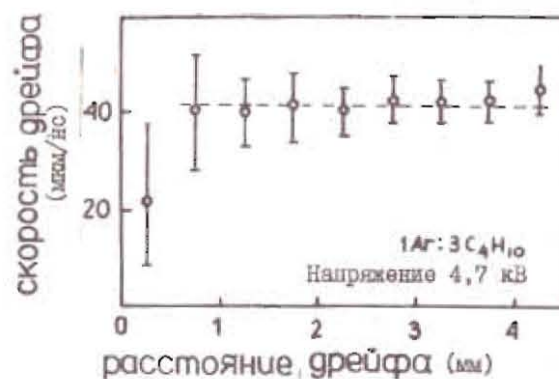
Рис. 10. Средневзвешенные значения скорости дрейфа в зависимости от места прохождения трека для смеси аргона с изобутаном в пропорции 1:3.
