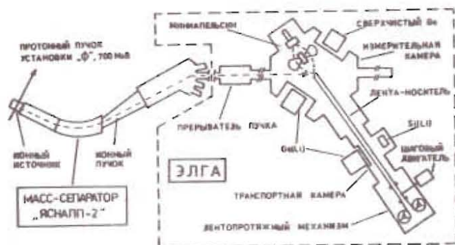
Рис. 1. Принципиальная схема установки ЭЛГА на пучке масс-сепаратора ЯСНАПП-2.
