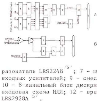
Рис. 1. Блок-схема измерения амплитудных /а/ и временных /б/ спектров многопроволочной пропорциональной камеры 3х1,5 м 2 : 1 - предварительный усилитель сигналов с проволоки; 2 - усилитель LRS333 5 ; 3 - ослабитель сигналов N9300 5 ; 4 - дискриминатор-формирователь N6009 5 ; 5 - схема совпадений N6234; 6 - аналого-цифровой преобразователь LRS2248 5 ; 7 - шины КАМАК; 8 - 16-канальный блок входных усилителей; 9 - смеситель аналоговых сигналов N3881; 10 - 8-канальный блок дискриминаторов-формирователей; 11 - 5-входная схема ИЛИ; 12 - времяцифровой преобразователь LRS2928A 5 .
