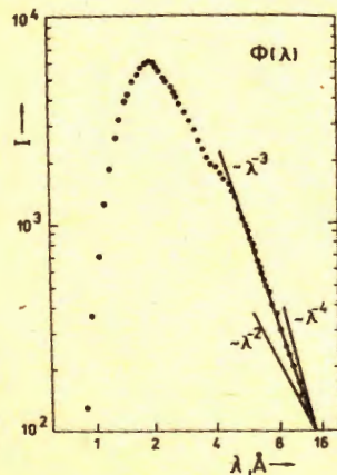
Рис. 6-2. Зависимость потока нейтронов от длины волны, измеренная детектором с эффективностью \epsilon \sim \lambda .
