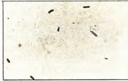
Рис.3. Треки на лавсане, облученном осколками деления от урановой мишени массой 30 \text{ мкг/см}^2 (интегральный поток нейтронов 6 \cdot 10^{10} \text{ н/см}^2 ).
