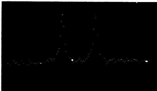
Рис. 10. Временные спектры, характеризующие пространственное разрешение камеры. Расстояние между двумя распределениями соответствует 700 мкм. Цена одного канала составляет 26 мкм.
