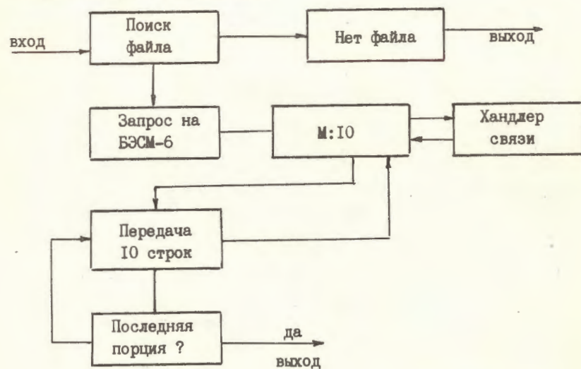
Рис.1. Логическая схема передачи задачи на БЭСМ-6.
