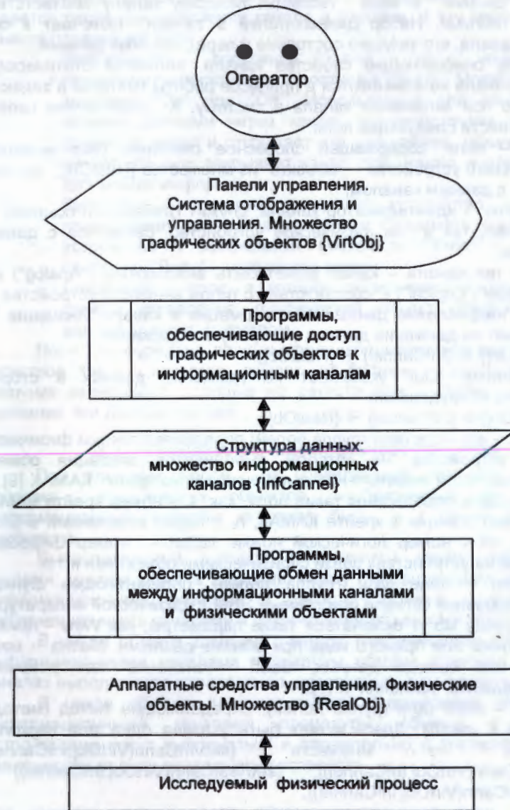
Рис. Схема обмена информацией между оператором и экспериментальной установкой
