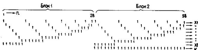
Рис. 2.. Структура кодирующей матрицы H_{56,9} , состоящей из двух подматриц H_{28,8} и H_{28,9} .
