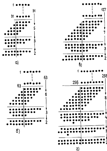
Рис.5. Структурная схема ЦММ, запрограммированная для выполнения операции умножения двух элементов в поле GF(2^3) .
