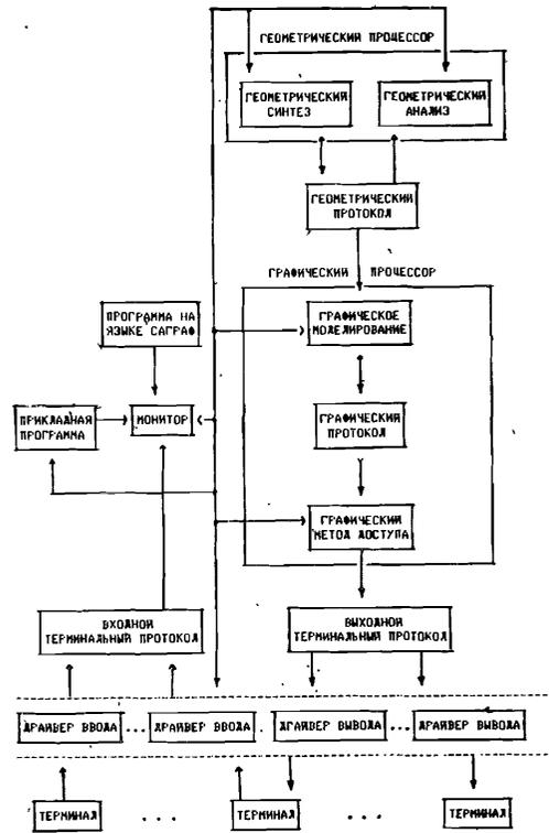
Геометрический процессор включает в себя две подсистемы - подсистему геометрического синтеза и подсистему геометрического анализа.
