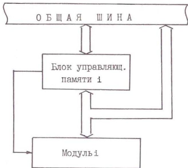
Рис.7. Подключение модуля к общей шине.
