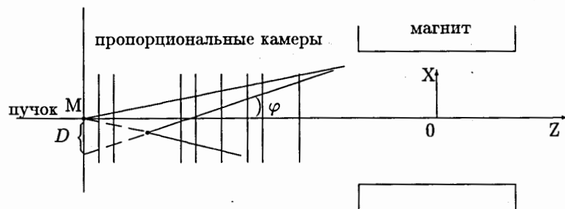
Рис. 1. Схема размещения мишени M , анализирующего магнита и координатных детекторов ( XOZ -проекция). Схема распада короткоживущей частицы
