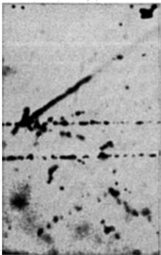
Рис.1 Микрофотография неупругого взаимодействия \alpha - частицы с вылетом по направлению пучка релятивистской двухзарядной частицы ( \text{He}^3 или \text{He}^4 ).
