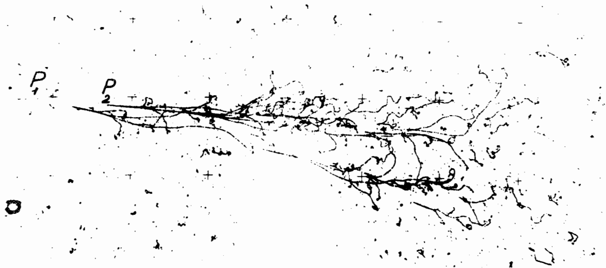
Рис.1. Типичный случай ливня, созданного \gamma -квантом в жидком ксеноне. P_1 - точка генерации \pi^0 , P_2 - точка конверсии \gamma -кванта. Полная энергия ливня E_\gamma = 1500 Мэв.
