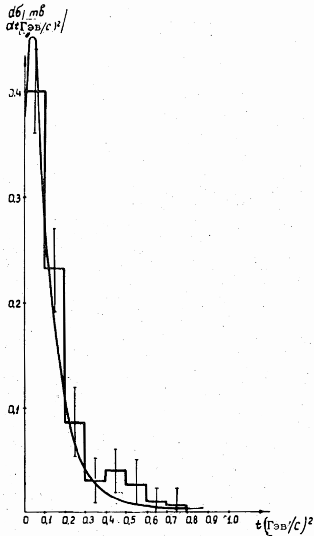
Рис.2. Сравнение экспериментального распределения дифференциального сечения реакции \pi^- + p \rightarrow \Lambda^0 (\Sigma^0) + K^0 с теоретической кривой (сплошная линия), вычисленной на основе модели Редже с обменом двумя полюсами K_{890}^{*0} и K_{1420}^{*0} .
