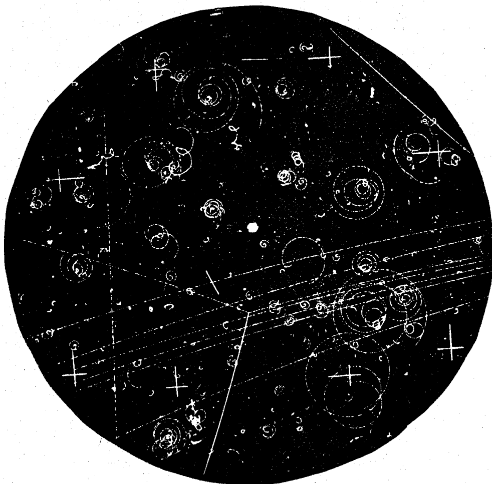
Рис. 14. Типичная фотография следов частиц в камере. Виден случай упругого взаимодействия \eta^- -мезонов с водородом.
