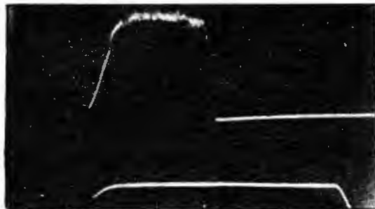
Р и с. 11. Форма импульса на дуантах циклотрона при возникновении в резонаторе плазменного разряда. Снизу видна верхушка модулирующего импульса.
