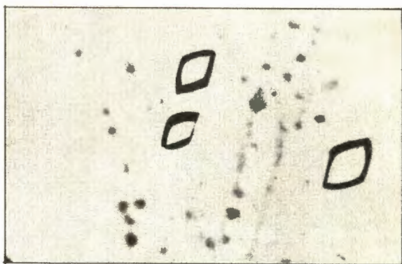
Рис. 2. Следы осколков деления на отожженной слюде, имевшей внутренние дефекты.
