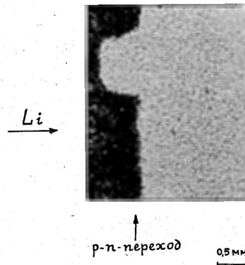
Рис. 1. Дефект p-n -перехода в кремниевом p-i-n -детекторе (образец 9), выявленный сухим позитивным электрофотографическим проявителем. Стрелкой указано направление диффузии и дрейфа ионов лития. Время дрейфа - 36 часов.
