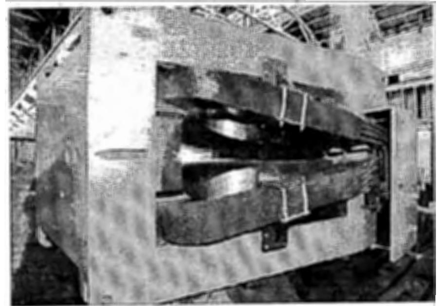
Fig.1. Analyzing multipole magnet M2 (12X55ECH164-1.125-25).
