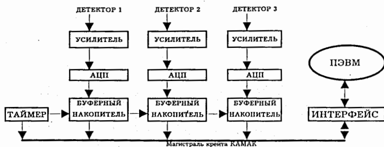
Рис.2. Блок-схема регистрирующей электроники.
