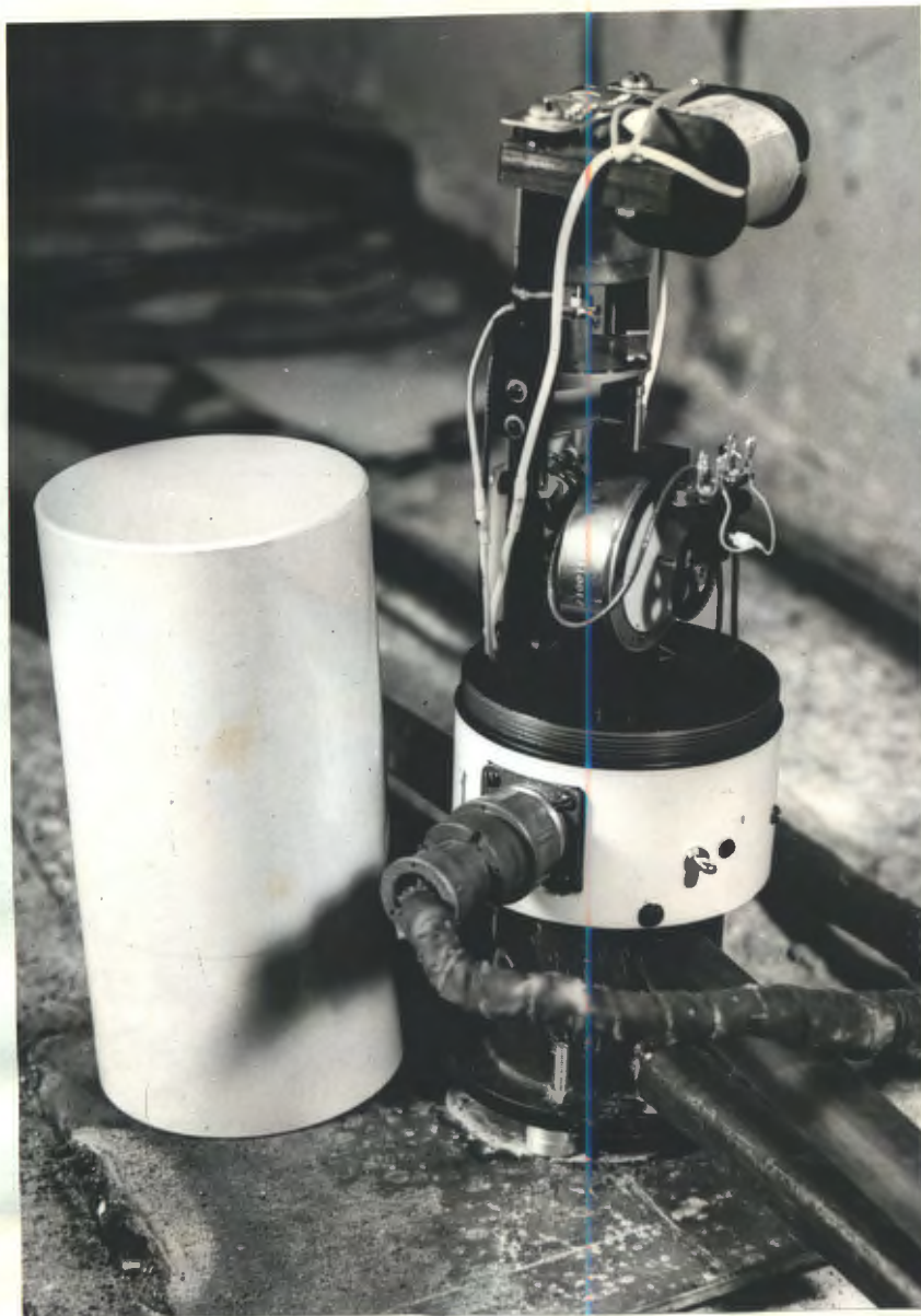
Рис. 8. Электроконтактный датчик гидростатической системы (крышка снята).
